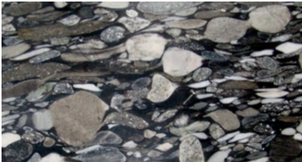
Ryc. 22. Zmetamorfizowany zlepieniec, widoczne spłaszczenie otoczków – fot. A.T. Solecki
